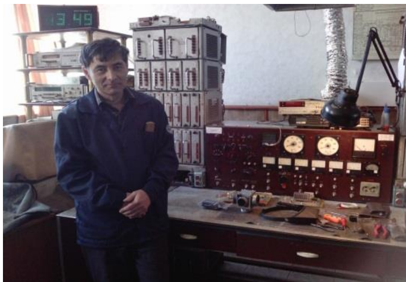
Фото - Алексей Бабичук и разработанный им новый стенд для проверки напряжения в силовой цепи электровоза
